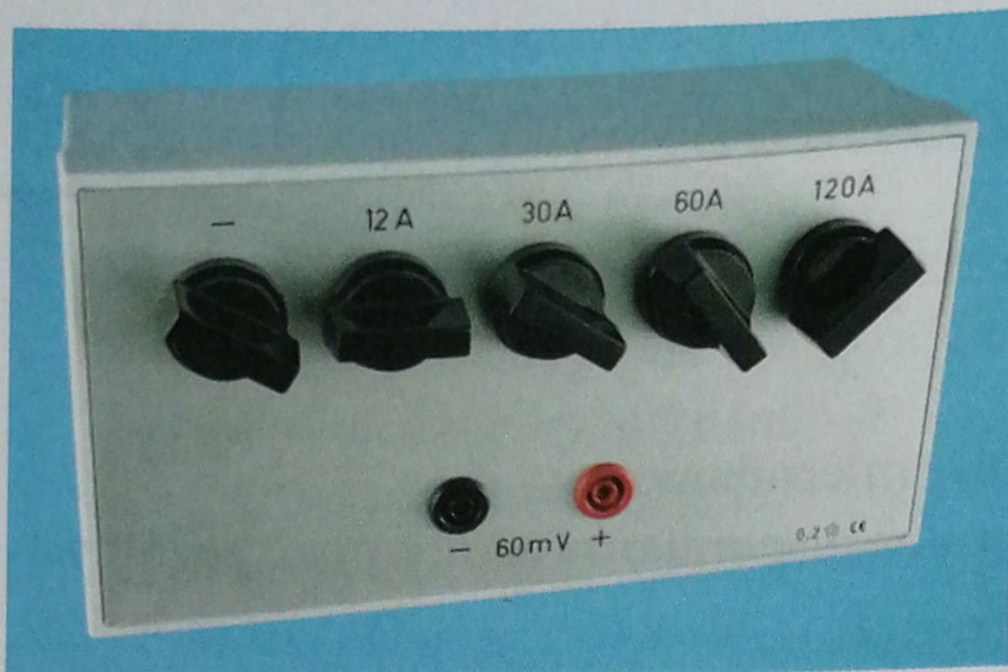
Rys. 2.33 Bocznik prądowy SH-2
